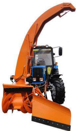
Рисунок 6.7. Универсальная снегоуборочная машина СУ2.1 ОПМ
