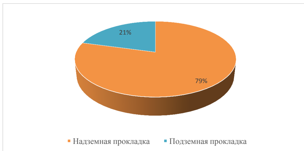
Рисунок 1.12. Распределение тепловых сетей котельной №7 по типу прокладки
